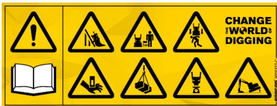
Afbeelding33. Waarschuwingsticker aan rechterzijde van de machinist.
